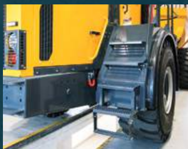
Montée et descente en toute sécurité hors des zones de danger et dans le champ de vision du conducteur.
