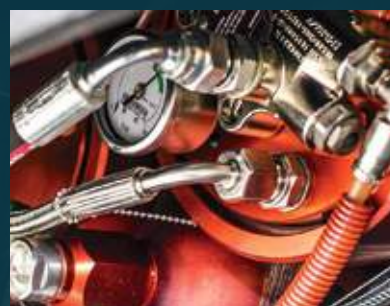
Extincteur et filtre à particules pour moteurs diesel, conformes aux exigences à remplir pour les travaux dans les tunnels.
