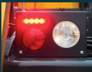
Feux arrière clignotants complétant les avertisseurs sonores pour la sécurité du conducteur et des autres personnes à proximité.
